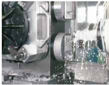
Fresatura orizzontale con cubi MTS dotati di sistema di serraggio.
