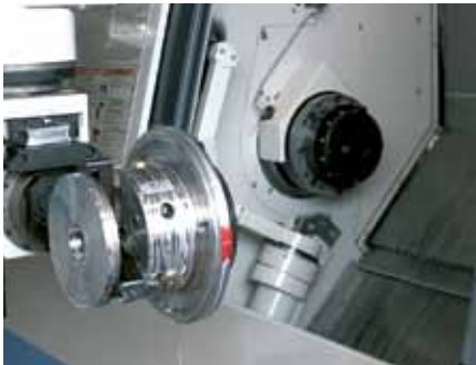
Tornitura con PC 210 e caricamento automatico.
