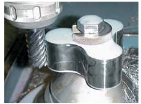
Fresatura HSC sul PowerChuck P completamente integrato.
