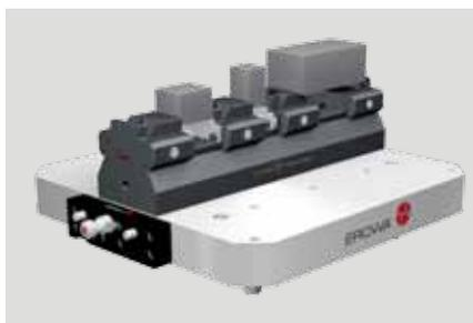
Serraggio multiplo su pallet MTS o UPC con una guida CleverClamp per una migliore accessibilità del pezzo. L'automatizzazione consente di aumentare il tempo di ciclo della macchina.
