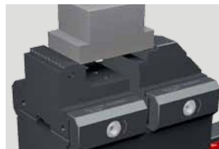
Serraggio di pezzi con altezza di serraggio minima.
