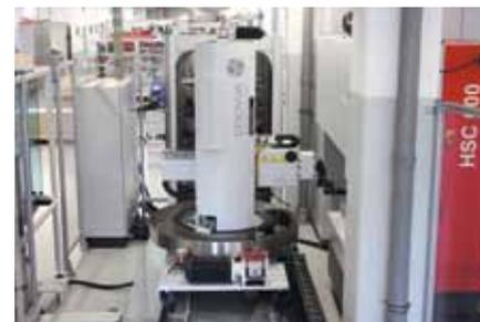
Una cella di produzione di elevata efficienza per l'automatizzazione di lavorazioni di pezzi singoli e piccole serie. Il robot EROWA Linear carica due centri di fresatura e una macchina di misura contemporaneamente.
