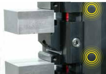
Per dispositivi di serraggio con pezzi ricorrenti: riconoscimento dei singoli pezzi con chip di identificazione e il sistema di gestione del processo Manufacturing Control di EROWA.
