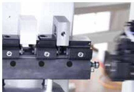
I pezzi da lavorare vengono pallettizzati e depositati nel magazzino del dispositivo di handling con CleverClamp. Il sistema di identificazione EWIS™ offre una panoramica dei posti magazzino e dei pallet.
