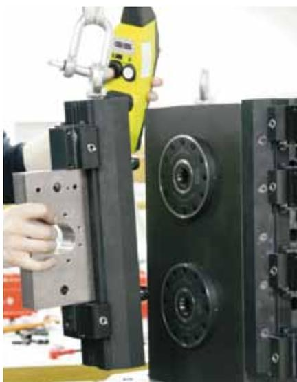
I dispositivi pesanti possono essere sollevati senza difficoltà con una gru. Le guide di base CleverClamp sono dotate di fori su entrambi i lati per applicare le viti ad anello.
