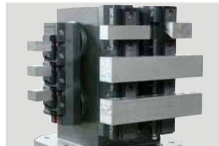
Serrare diversi pezzi e sfruttare il campo di lavoro della macchina in modo ottimale: CleverClamp montato sulla torretta in ghisa minerale di EROWA.
