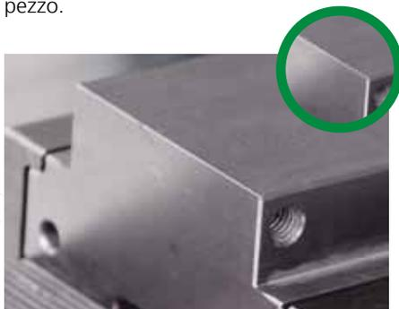
**Lato di serraggio e di arresto liscio**
