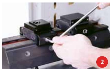
Posizionare e fissare l'elemento di serraggio in base alle dimensioni del pezzo.
