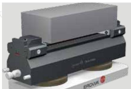
CleverClamp di EROWA per il serraggio di pezzi di grandi dimensioni con elevate forze di arresto.
