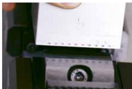
**Geniale profilo in rilievo** - i pezzi vengono serrati geometricamente o dinamicamente a un'altezza di serraggio minima di 3 mm con una forza di arresto fino a 1,6 tonnellate (elemento lineare). Ciò consente di raggiungere forze di arresto massime. Se necessario, il pezzo può essere lavorato pressoché completamente sui 5 lati.
