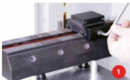
Predisposizione e attrezzaggio con poche operazioni. Posizionare e fissare l'elemento di battuta.
