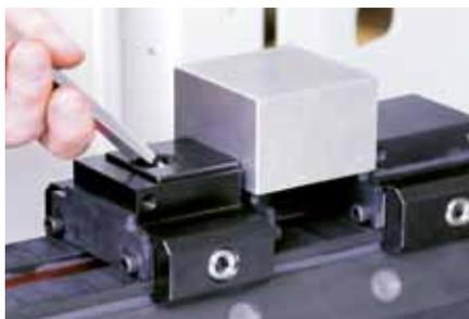
Con l'attrezzaggio e il presettaggio dei pezzi fuori dalla macchina utensile si può sfruttare il tempo in modo ottimale e ridurre i costi.
