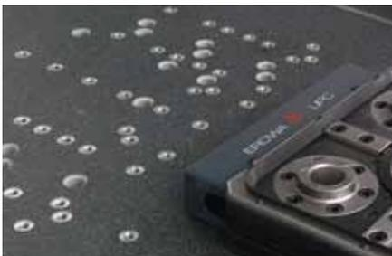
I sistemi di serraggio EROWA possono essere montati direttamente sulla tavola in granito grazie alla configurazione dei fori standard.
