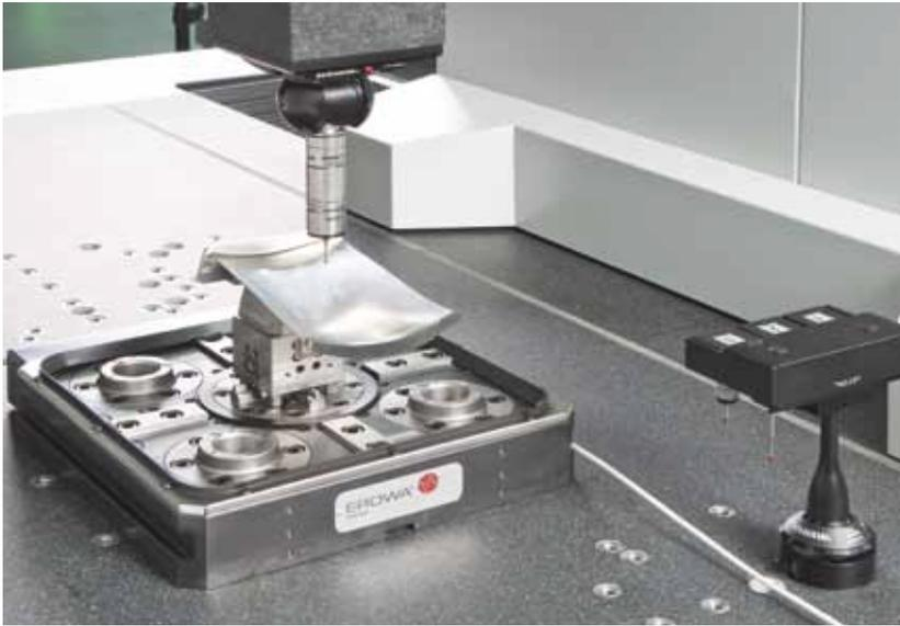
Nella "misurazione normale" vengono acquisiti solo punti singoli. Con la scansione vengono rilevati molteplici dati. Pertanto si ottengono informazioni sostanzialmente più precise su forma e morfologia del pezzo.
