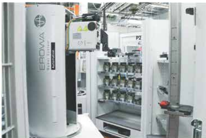
A seconda della dimensione pallet, il robot prende la pinza adeguata nel magazzino pinze.
