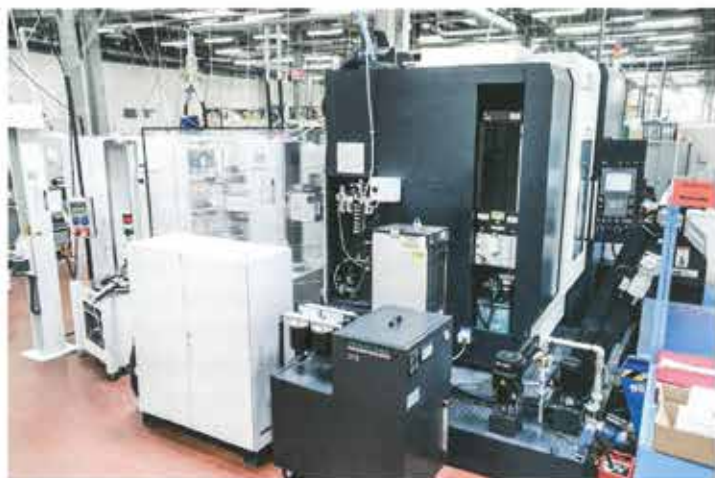
Centro di fresatura MAKINO D500 con Robot System EROWA, stazione di carico e magazzini pezzi.
