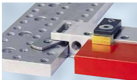
La base solleva la barra di serraggio con appoggio fisso a Z=0 .
