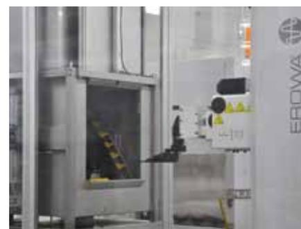
Il robot carica la stazione di lavaggio e pulizia EROWA con i pezzi pallettizzati. Dopo la pulizia il robot preleva il pezzo e lo porta sulla macchina di misura per il controllo intermedio. In questo modo il controllo qualità integrato nel processo non è più un ostacolo.
