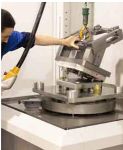
Nella stazione di carico l'operatore prepara i job successivi, mentre il robot continua a fornire il lavoro alla macchina.
