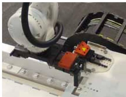
Cambio pinza efficiente: la pinza di sistema adatta è sempre a disposizione nella stazione pinza integrata.
