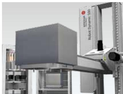
Pallet MTS grandi con pezzi fino a 800 x 800 x 500 mm vengono caricati senza alcun problema sulla macchina con il nuovo sistema pinza intercambiabile.
