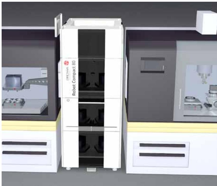
Una cella di produzione con due macchine e un EROWA Robot Compact 80 richiede poco spazio. Produttività concentrata in soli 2 m<sup>2</sup> di superficie d'appoggio. Il Robot Compact conferisce grande autonomia alla macchina.
