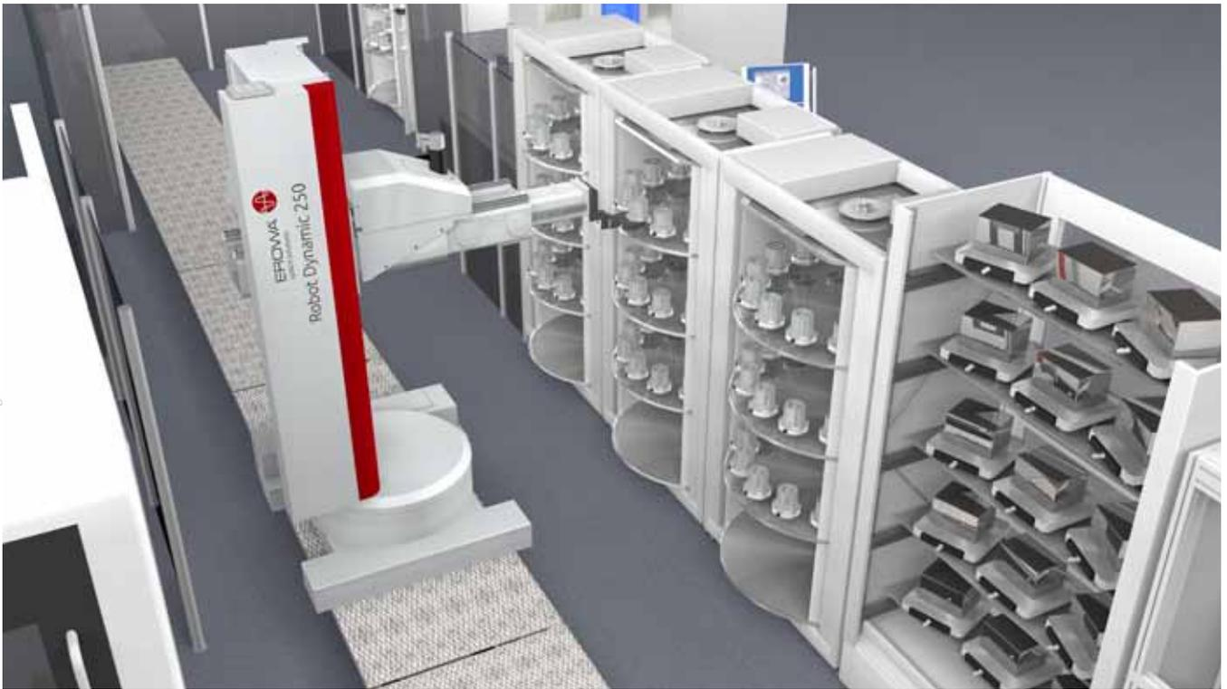
Il Robot Dynamic è idoneo al caricamento di pezzi grandi e piccoli. Il cambio automatico dei pallet di diverse dimensioni all'interno dell'impianto è una delle caratteristiche fondamentali nella produzione automatica di pezzi singoli e piccole serie.
