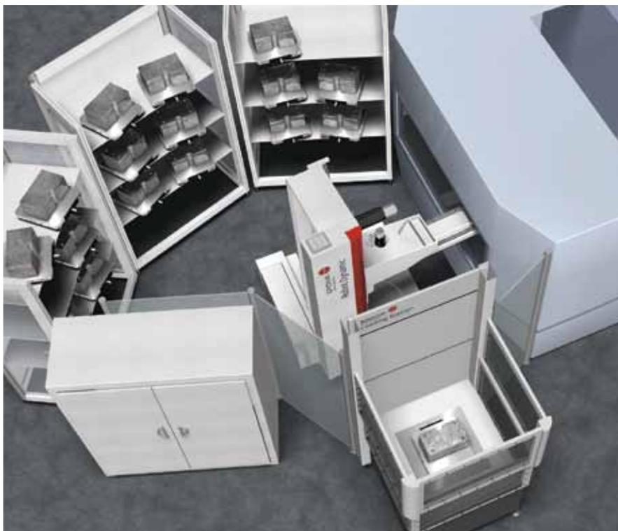
Un impianto di elevata efficienza per l'automatizzazione di lavorazioni di pezzi singoli e piccole serie. I pezzi vengono caricati e scaricati tramite la stazione di attrezzaggio e carico integrata. Se necessario, si aggiunge semplicemente un ulteriore magazzino.
