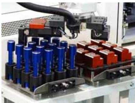
A seconda dell'ordine il robot trasporta pezzi grezzi, pezzi pallettizzati e dispositivi sulla macchina. I complessi processi sono pianificati, monitorati e valutati dal sistema di gestione della produzione di EROWA.
