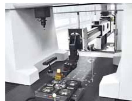
Anche le unità di misurazione, come la CMM Qi, vengono integrate nel processo di produzione generale e caricate automaticamente.
