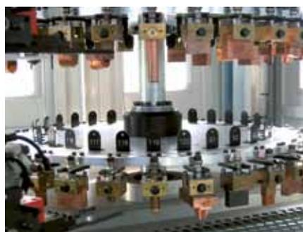
Per ogni piano magazzino sono disponibili 30 posizioni per portaelettrodi. Con un massimo di 9 piani si ottengono 270 posti. Nella produzione di serie EROWA Robot Multi aumenta la produttività delle macchine CNC in modo esponenziale.
