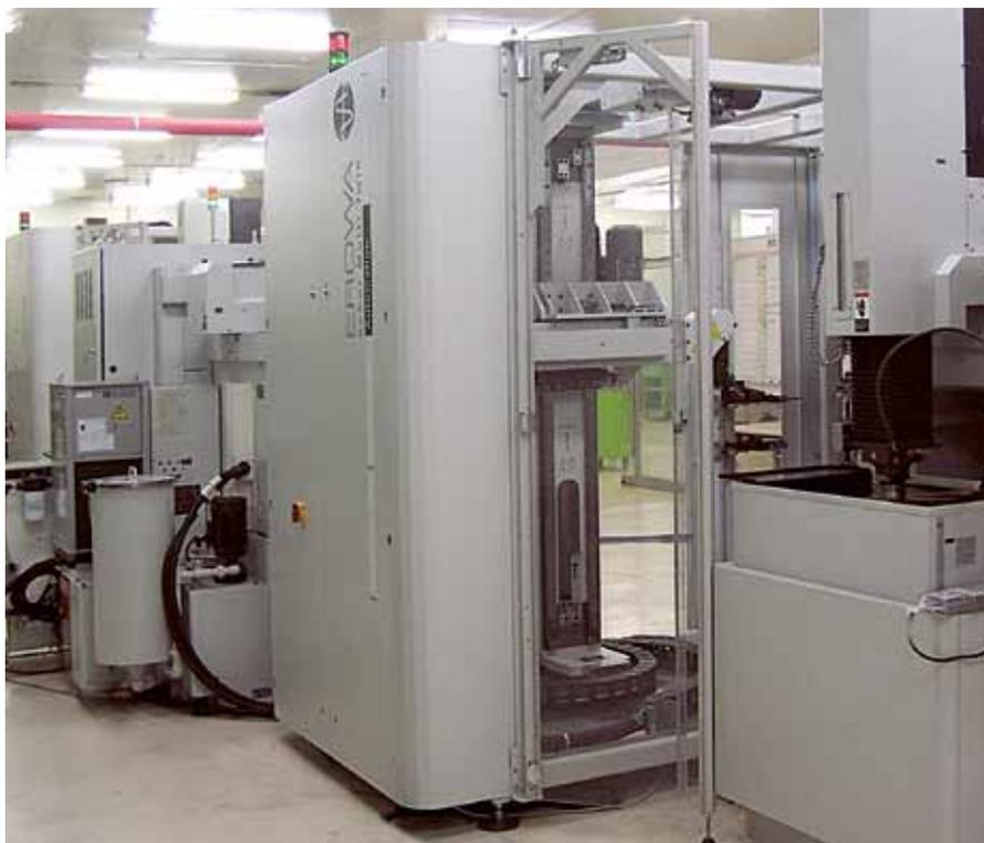
Due macchine, un robot. Le celle vengono comandate singolarmente tramite il sistema di gestione del processo. Il robot è in comune.
