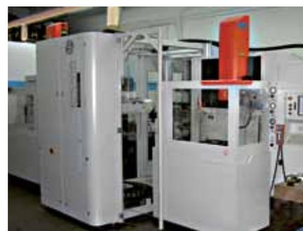
Il Robot Multi è idoneo per il caricamento di qualsiasi macchina, in orizzontale o verticale, su tavola o testa macchina.
