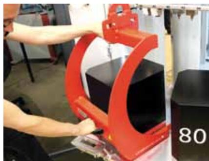
I pezzi pesanti vengono caricati direttamente sui piani magazzino estraibili con il carro ponte o con un EROWA Lift.
