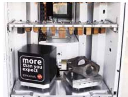
Piani magazzino (esempio) per due posizioni di pallet UPC 320. Trasbordo dalla stazione di carico integrata (optional), 80 kg di capacità di trasferimento: la nuova dimensione nella fascia di prezzo più bassa!
