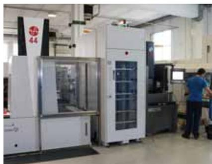
Il robot carica la macchina EDM con pezzi preimpostati e pallettizzati. Inoltre i pezzi finiti vengono forniti alla macchina di misura CNC con un ciclo regolare. I pezzi vengono misurati automaticamente e gli eventuali errori di produzione sono inoltrati direttamente all'operatore.
