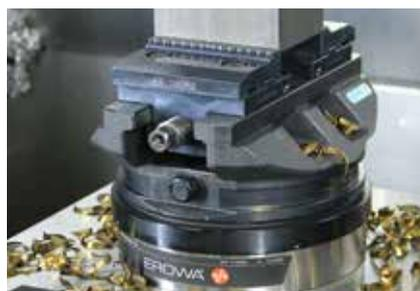
I mandrini PowerChuck P sono una base precisa per i portapezzi. La forza di serraggio di 10'000 N assicura un fissaggio potente e affidabile durante la lavorazione del pezzo.
