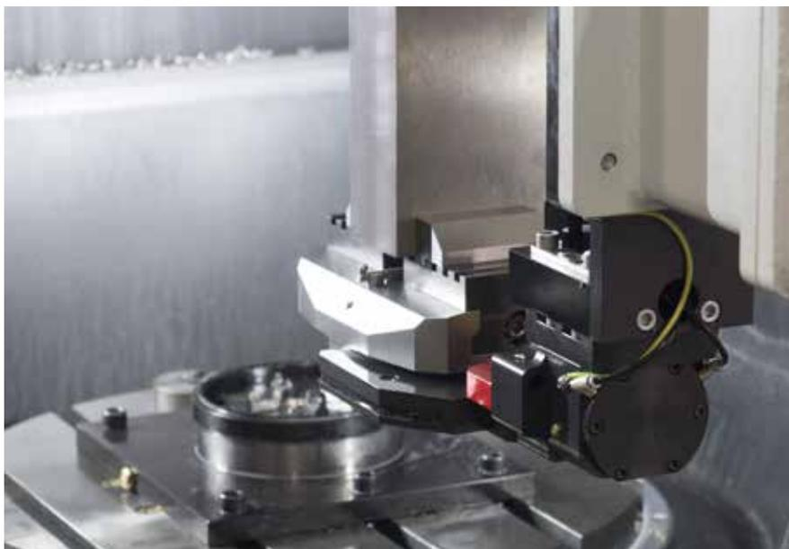
Il sistema di palettizzazione PowerChuck P è automatizzabile. EROWA offre il dispositivo di handling giusto per ogni applicazione e per tutte le tecnologie. Gli anelli di tenuta proteggono il mandrino e garantiscono un caricamento automatico sicuro.
