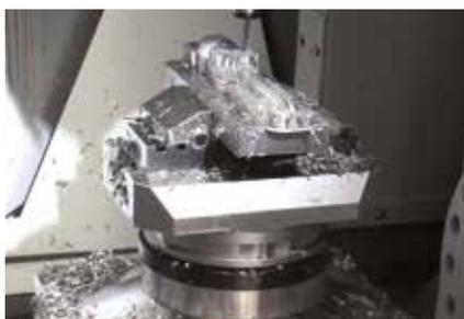
La struttura compatta e l'altezza di montaggio ridotta del sistema di serraggio lasciano molto spazio per i pezzi e la loro lavorazione.
