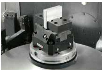
Semplicemente pratico - Con il modello PowerChuck P con passaggio per aria compressa i dispositivi di serraggio vengono azionati pneumaticamente attraverso i pallet e il mandrino.
