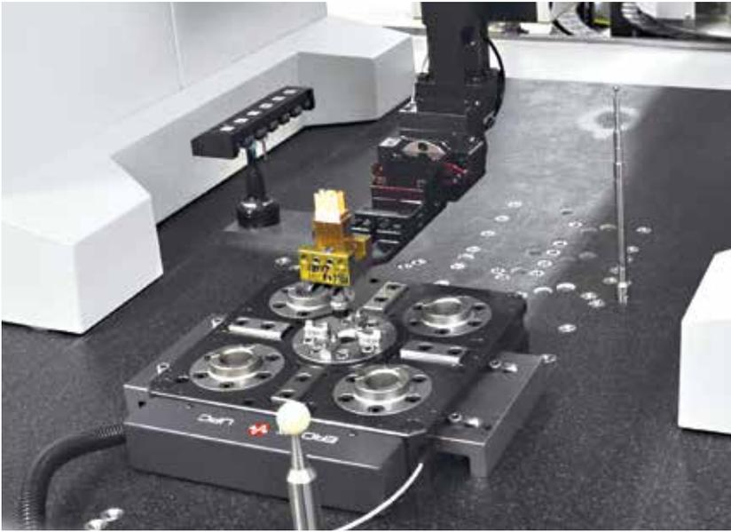
Anche la fase di processo "Misurazione qualità" può essere tranquillamente automatizzata. Un potenziale stallo viene eliminato effettuando le misurazioni automaticamente nel secondo e terzo turno.
