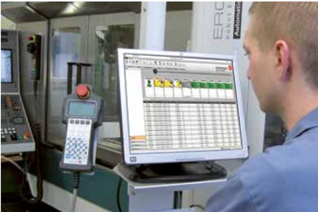
Una cella di produzione è composta dalla macchina, dal robot EROWA e dal terminale per il sistema di gestione del processo. In questo modo l'operatore ha tutto sotto controllo.
