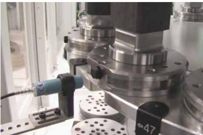
I pallet pronti con i pezzi sono contrassegnati in modo inequivocabile con un chip. In ogni stazione del processo di produzione si può effettuare l'identificazione univoca con il sistema EROWA EWIS™.
