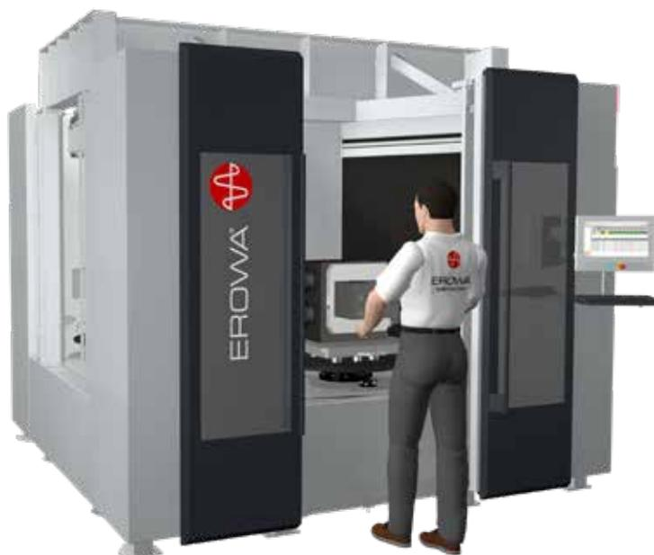
Con la funzione dell'avvolgibile (optional) l'intera area del magazzino rimane pulita anche se sulla stazione di attrezzaggio viene eseguita la pulizia con aria compressa.
