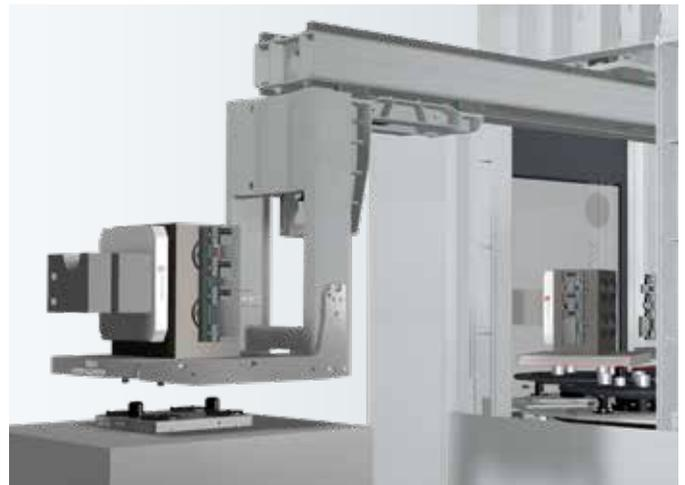
Stabile asse di trasferimento con pinza a forcella. Portata di 2 metri dal bordo esterno del robot.
