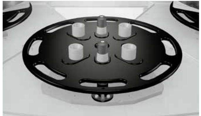
I piatti magazzino girevoli semplificano l'attrezzaggio e l'allestimento. Il precentraggio facilita il posizionamento dei pallet con grù e LiftGear.
