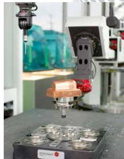
Presettaggio di elettrodi e pezzi e controllo di qualità con redazione del protocollo di misurazione.
