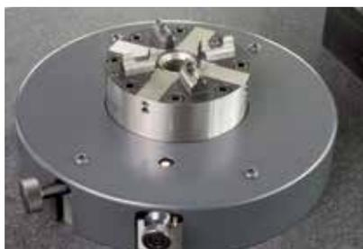
Con la massima precisione, il cuscinetto d'aria simula l'asse C sulla macchina per elettroerosione. La rotazione perfettamente concentrica rivela ogni minimo errore sull'elettrodo.
