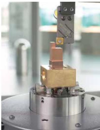
Allineamento e individuazione dei valori di presettaggio su elettrodi e pezzi.
