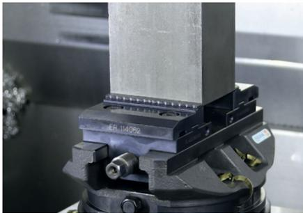
La morsa per pezzi grezzi consente un serraggio potente e sicuro fino a 35 kN.
