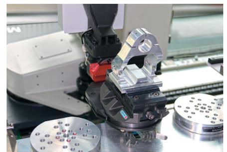
Caricamento automatizzato: il pallet viene preparato per EWIS Chip ed è dotato di una scanalatura relativa. Viene così prelevato con la pinza del robot.
